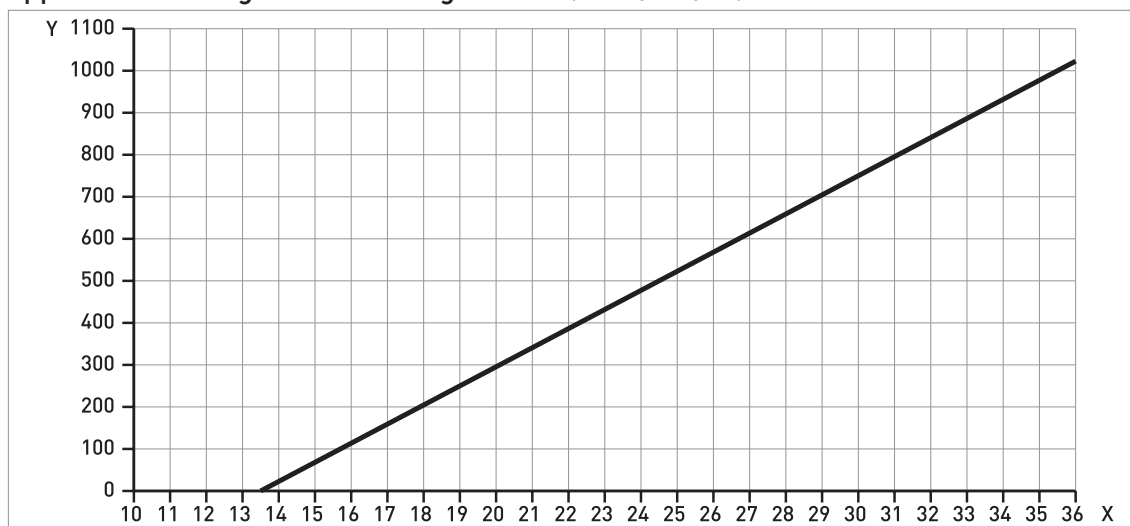
Figure 2-2: Tension minimale d'alimentation aux bornes pour une sortie de 22 mA (homologation pour zones dangereuses (Ex d / XP/NI))
